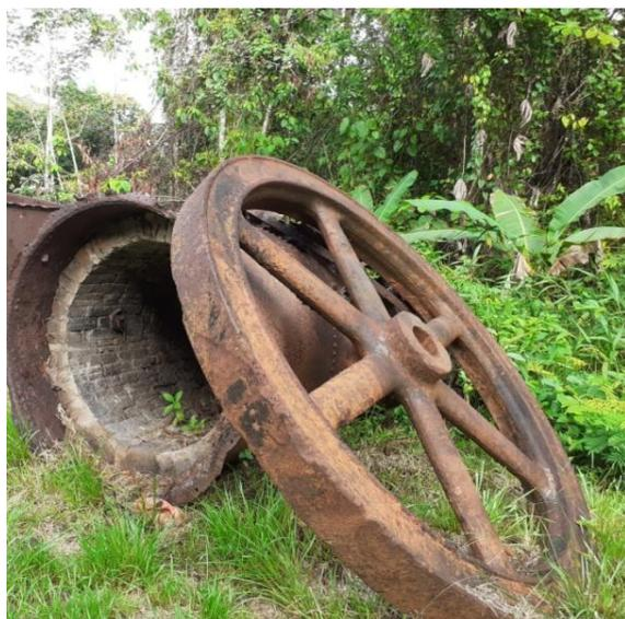
*Machine à vapeur cylindrique, avec son revêtement intérieur en brique pour tenir la chaleur ; cette machine est un générateur de vapeur qui actionne un moteur destiné à mettre en mouvement un concasseur par l'intermédiaire de courroies.*
