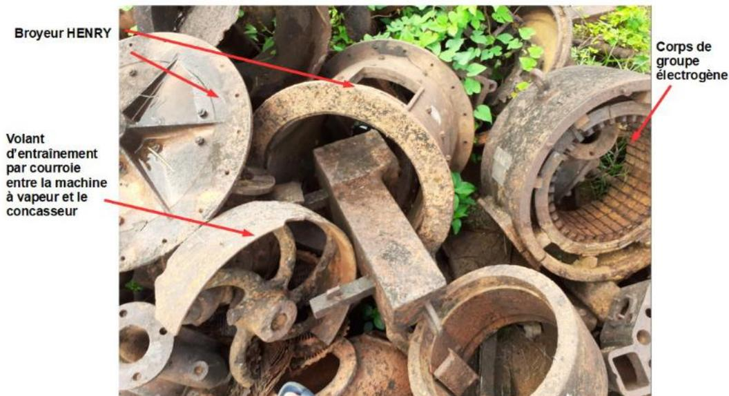
*Petit broyeur à boulet de marque HENRY, une sorte de tonneau métallique qui tournait et dans lequel étaient mélangés des boulets d'acier et le minerai à broyer. C'est la dernière étape du broyage pour un produit fin.
